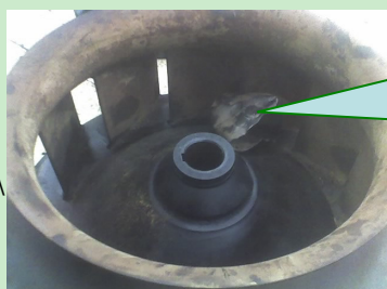
Figura 3 – Fotografia da turbina do ventilador onde se observa o componente solto.
