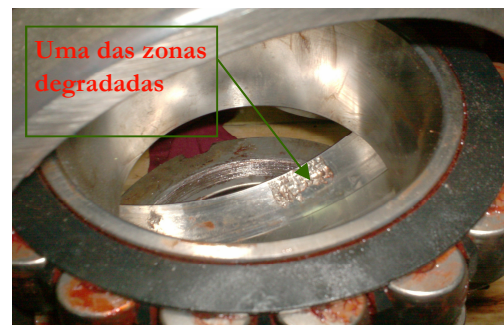
Figura 5— Fotografia do rolamento após a substituição revelando a degradação
