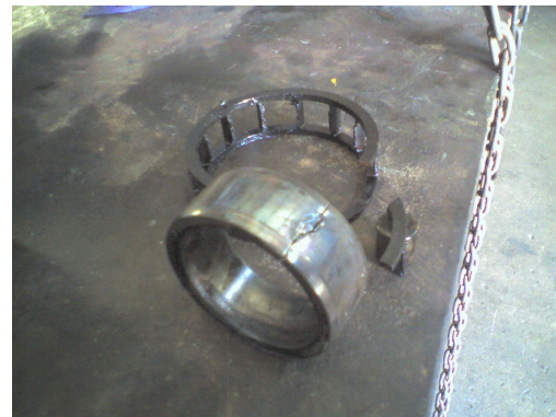
Figura 4 – Anel interno e gaiola do rolamento substituído
