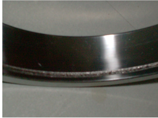
Figura 4 - Fotografia da pista do anel externo do rolamento SKF 1315
