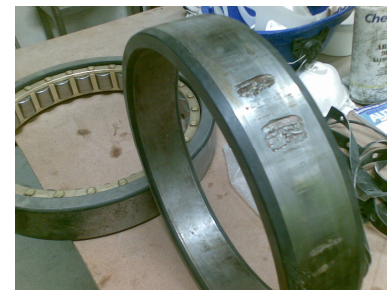
Figura 4 – Fotografia da pista do anel interno do rolamento do motor, evidenciando a acentuada degradação
