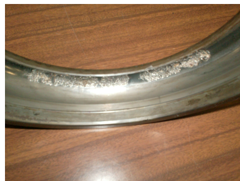
Figura 5 - Fotografia mostrando a pista do anel externo do rolamento substituído
